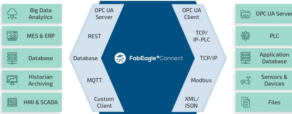
FabEagle®Connect kann für die Realisierung der Schnittstellenlösung auf verschiedenen Plattformen eingesetzt werden: Windows 10, Windows 11, Yocto Linux und KontronOS. Für die fabrikkweite Umsetzung von Schnittstellenaufgaben wird auf zentrale Serversysteme gesetzt. Auch Windows-basierte IoT-Gateways und Edge-Devices werden für eine möglichst maschinennahe Implementierung unterstützt.
