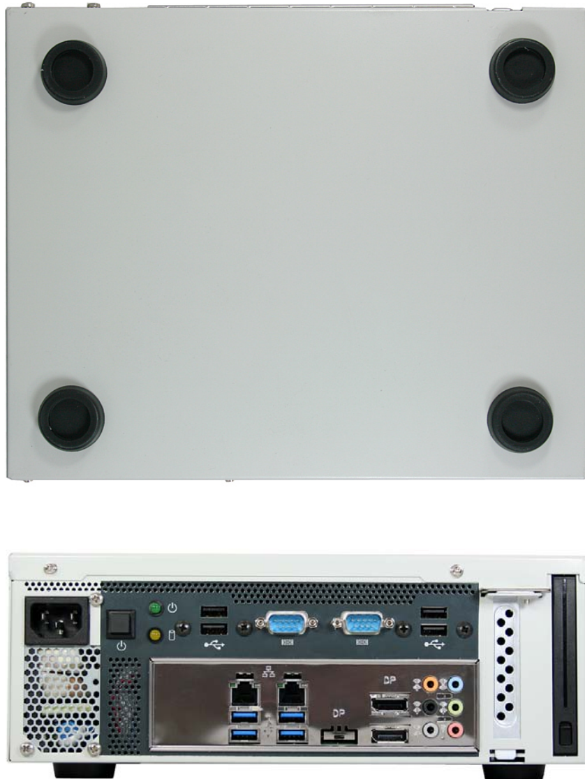
Abb. 19: KBox B-101 als Desktop-Variante mit aufgeklebten GummifüÙen
